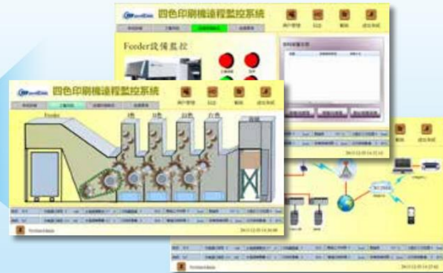
印刷機設備監控系統畫面
