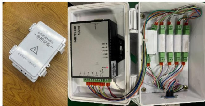
箱體規劃(包覆裡面的SMB與線材防止因棉絮故障)
