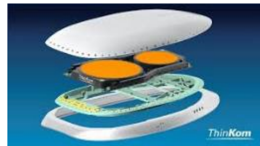
多軌多頻衛星地面設備(含陣列天線)示意圖
